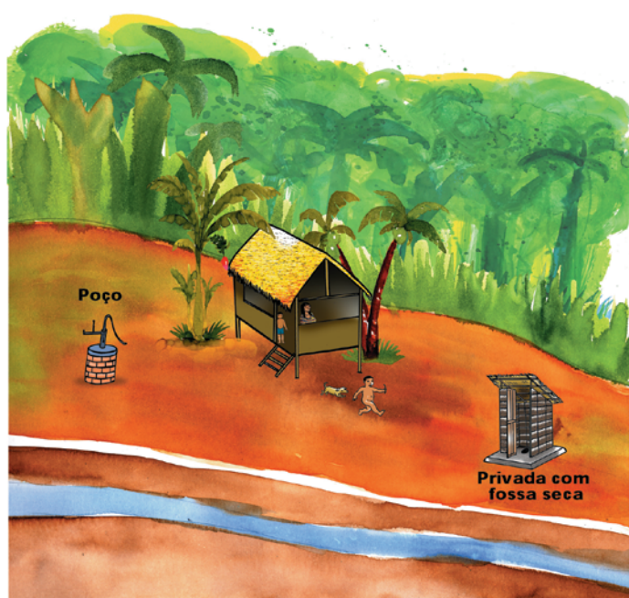
Localização correta da privada com fossa seca
