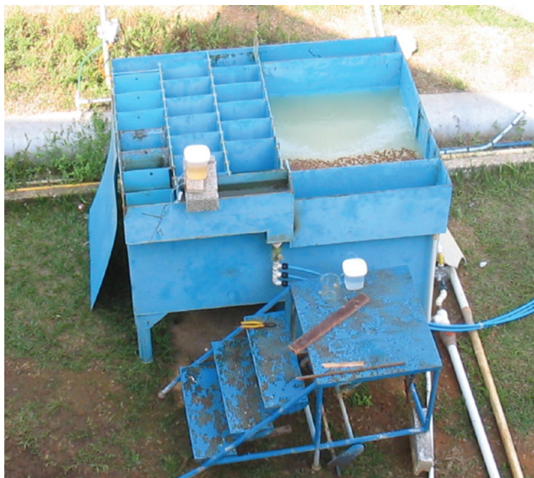
Figura 2 – ETA piloto onde foram desenvolvidos os experimentos, ao lado da ETA Duas Bocas, em campo, próximo à barragem
