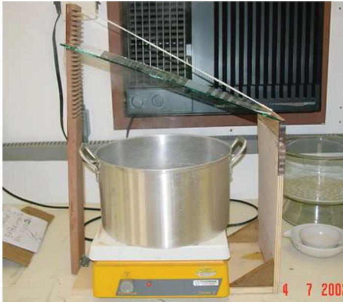
Quatro pirâmides de vidro (Figura 3) foram construídas com inclinações de 15°, 25°, 30° e 45°, conservando-se a mesma área da base, aplicando-se temperaturas na atmosfera interna de 50°, 60°, 70° e 80° e temperaturas na água de 60°, 70° e 80° para cada inclinação.
